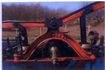
Ložisko vahadla a výtlačný ventil
